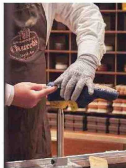
Tramite il metodo di lavorazione "Goodyear", le soles delle iconiche calzature CHURCH'S possono essere rimosse e sostituite in un secondo momento senza intaccare la struttura della tomaia.
